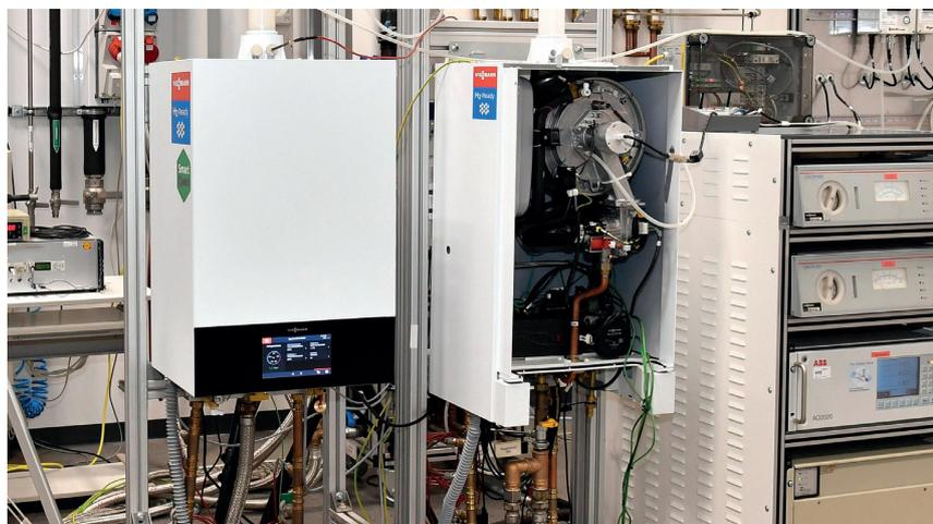
Les premiers prototypes sont actuellement testés dans le Centre Technologique Viessmann pour la compatibilité avec les mélanges contenant 100 % d'hydrogène.
