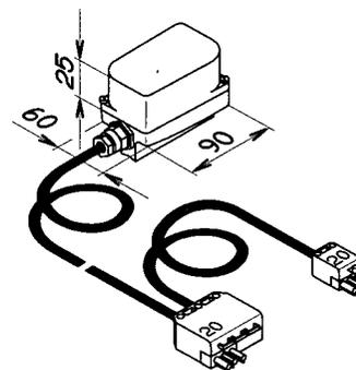
Avec câble de raccordement (longueur : 4 m et 0,8 m environ) et fiches.
