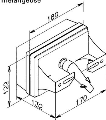
La régulation à action sur vanne mélangeuse sera montée directement sur la vanne mélangeuse Viessmann DN 20 à 32 et R 1/2 à 1 1/4.
