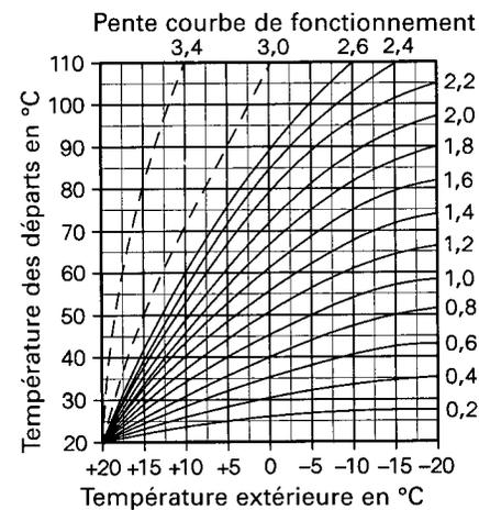
La température d'eau de chaudière est limitée vers le haut par l'aquastat de surveillance et à la consigne du limiteur électronique de température maximale.
