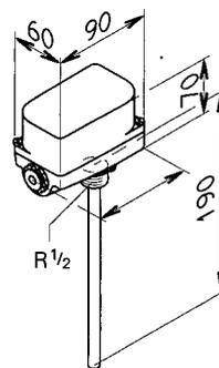
L'aquastat de surveillance sera implanté dans le départ chauffage et arrêtera la pompe de circuit de chauffage si la température des départs dépasse la consigne maxi.
