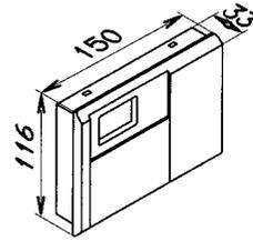
À mettre en place dans l'Eurolamatik-OC si le module de commande Comfortrol de l'Eurolamatik-OC est employé comme commande à distance.
