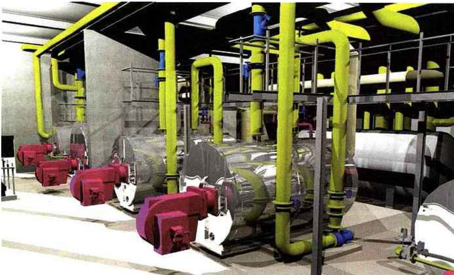
La nouvelle installation a préalablement fait l'objet d'un dessin en 3D pour accélérer le montage dans un délai court. On voit à l'arrière des chaudières le ballon tampon d'un volume de 30 m 3 .
