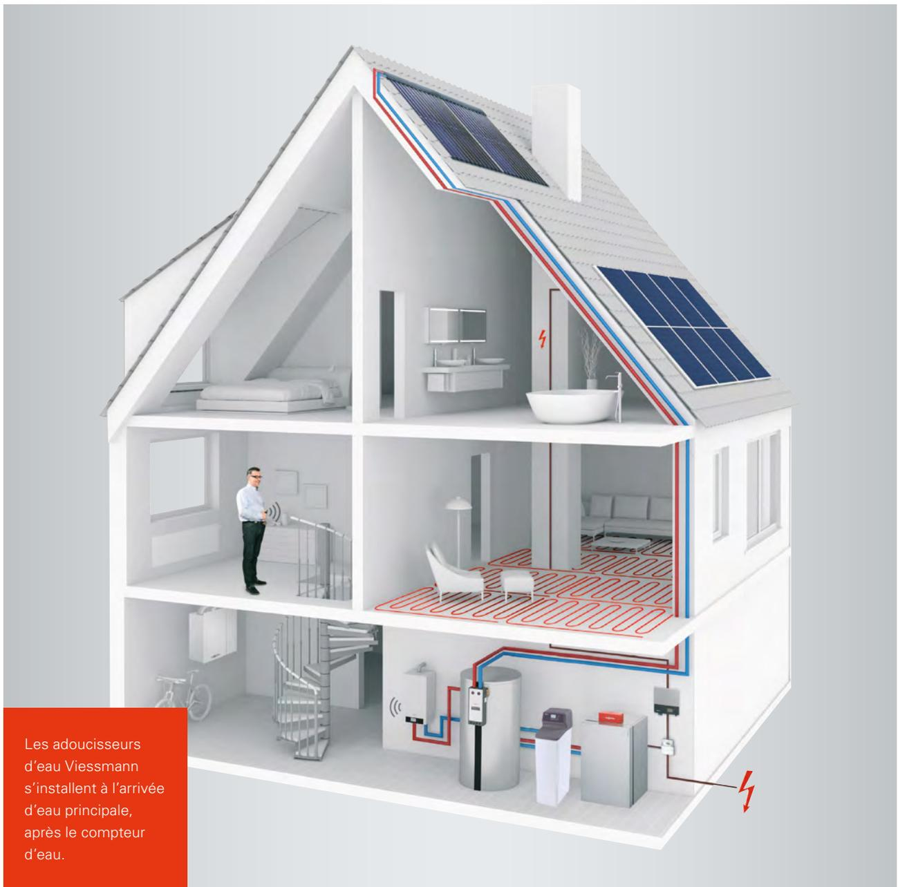
Les adoucisseurs d'eau Viessmann s'installent à l'arrivée d'eau principale, après le compteur d'eau.
